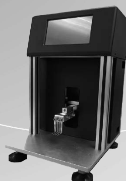
อุปกรณ์ทดสอบความแข็งของอาหารด้วยส้อม (Fork Tester)
