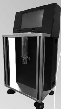
อุปกรณ์ทดสอบการไหลของเครื่องดื่มน้ำ (Flow Tester).
